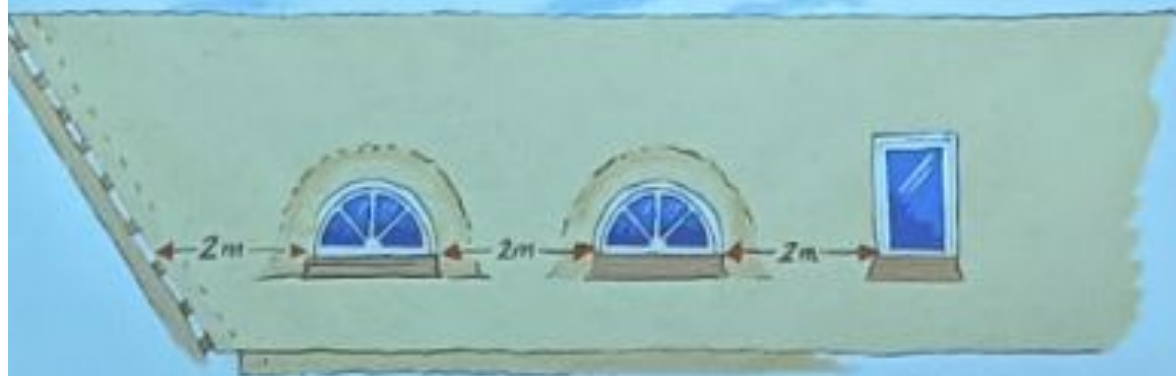
Figur 41. Minimumsafstand mellem kviste/overlys/sikstrende/skonsten
